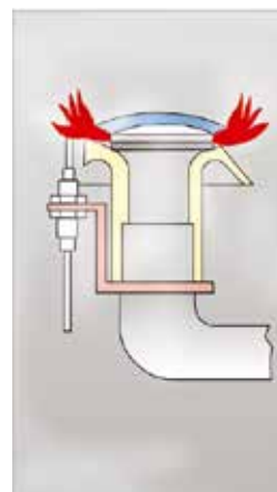
Sl.12. Plavičasti plamen bez žutih vrhova i bez dima znak je da je usklađen omjer plina i zraka potreban za normalno i potpuno sagorijevanje plina. Plamen na pomoćnom plameniku mora biti dug 35-40 mm. Treba izbjegavati suviše malen plamen jer bi se on mogao ugasiiti iznenadnim zračnim strujanjem, prelijevanjem hrane ili pogrešno izvedenom instalacijom. Duljina svih plamičaka na plamenicima mora biti izjednačena te moraju gorjeti svjetlo plavim plamenom.
