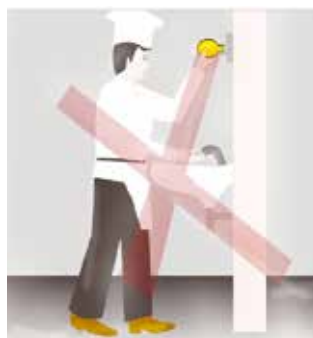
Sl. 8. Istovremeni dodir tijela pod naponom i npr. vodovodne metalne cijevi stvara se opasnost strujnog udara. Pri zamjeni žarulje ili otvaranje električnih uređaja, treba najprije isključiti napon. Električna trošila i uređaji moraju se redovito održavati, a u periodičkim razmacima pregledavati i ispitivati od kvalificirane osobe.
