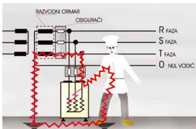
Sl. 6. Indirektni napon dodira nastaje kada metalno kućište koje inače nije pod naponom- npr. bojler, električni štednjak i sl. uslijed proboja izolacije i sl. dođe pod napon (napon greške). Što je manji otpor prolasku električne struje kroz tijelo čovjeka i veći napon na kućištu, kroz čovjeka prolazi jača struja prema poznatom izrazu I = U/R . (I jakost struje u amperima, U je napon u voltima te R otpor u omima). Važno je i vrijeme trajanje udara. Smrt može nastupiti kada je napon izmjenične struje veći od 50 V (u normalnim uvjetima), ali i kod manjeg napona u ekstremnoj vlažnosti i dodira s metalom po većoj površini tijela.
