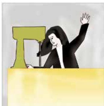
Sl. 11. Ne naginjati se iznad strojeva u radu i ne dodirivati ga tijelom. Ravne osovine, kardanski zglobovi i sl. mogu zahvatiti kosu i odjeću. Neprikladna odjeća bez manžeta na rukavima i nogavicama, duga kosa, marame, šalovi, kravate, nakit i sl. mogu se zaplesti za pokretni dio stroja i izazvati nezgodu.
