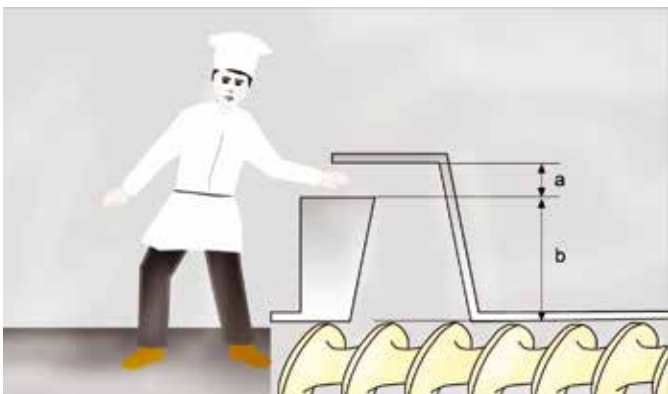
Sl. 10. Pristup radnika u opasno područje mora se onemogućiti zaštitnim napravama. Visina ulaza "a" do stroja je izvedena namjerno tako da se ruka ne može uvući unutra. Ukoliko visina „a“ omogućava ulazak ruke, onda "b" mora biti toliki da ruka ne može doći do noža.
