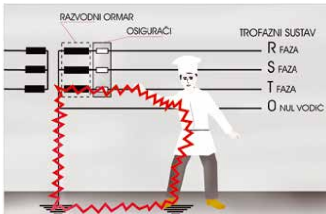
Sl. 5. Strujni udar uslijed direktnog napona dodira čovjek je dotaknuo tzv. fazu sustava koja ima napon prema zemlji 220 V pri čemu se preko tijela zatvara strujni krug.
